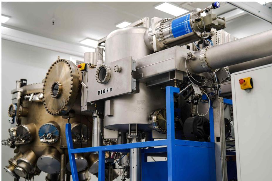
사진 4. (주)아이브이웍스 생산 장비(4gen Hybrid-MBE)
